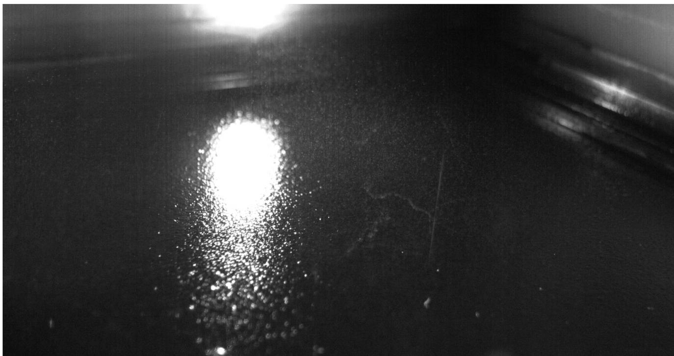
FIGURE 12 – Photo de la chambre en fonctionnement. Plusieurs types de trajectoires sont visibles : rectilignes, sinueuses, plus ou moins brillantes.
